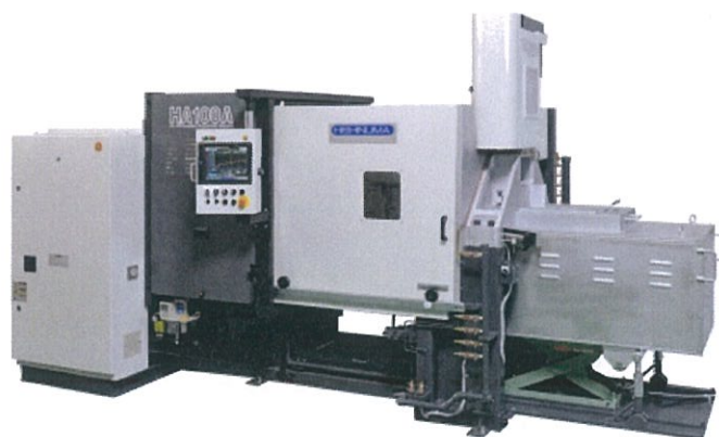
図1. 株式会社ヒシヌママシナリーと共同開発したアルミホットチャンバーダイカストマシン
